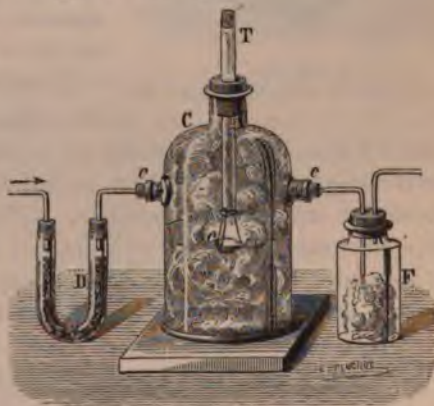
Fig. 11. Combustion du phosphore dans l'oxygène.
